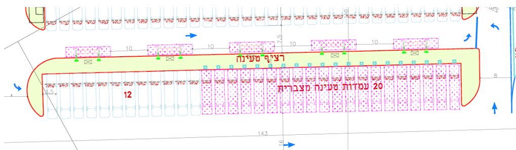
תכנון עמדות טעינה לאוטובוסים חשמליים המונעים במצברים "וקבלי על" במתחם אחד - מסוף כפר סבא מזרח. 1
